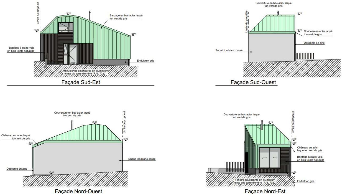
Il s'agit d'un plan précis représentant fidèlement l'aspect extérieur d'une construction. (Façade et toiture). Il doit être réalisé à l'échelle.
